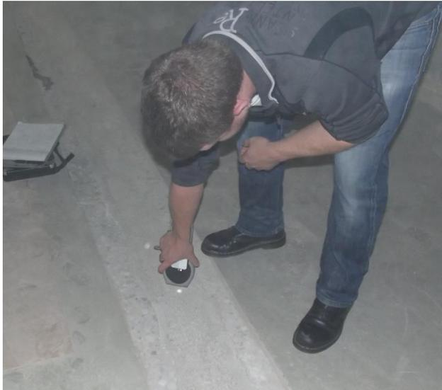
Die Auslesung der Daten erfolgte manuell per Handlesegerät, wobei die Auswahl der Lesegeräte (10 cm / 30 cm) den Einbautiefen der Sensoren entsprechen muss. Zusätzlich ist eine Fernabfrage der Sensoren möglich, um z.B. die Inspektionsfristen zu steuern.
